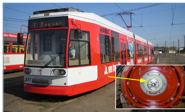
Abb. 1: Diese elektrische Straßenbahn in Halle (Saale), Deutschland, wies Lagerschäden durch umrichterinduzierte Spannungen auf. Das Problem wurde 2007 durch Einbau von AEGIS® SGR Lagerschutzringen (kleines Bild) an den Wellen aller Antriebsmotoren in der Flotte gelöst. Die Stadt betreibt seit 1891 ein Straßenbahnnetz.
