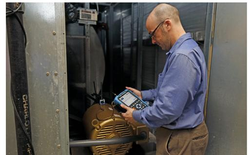
Messung von Wellenspannung mit dem AEGIS® Shaft Voltage Tester™
