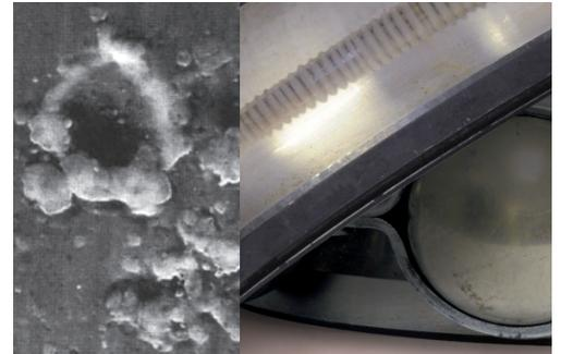
Verhinderung von Lagerschäden durch Stromdurchgang
